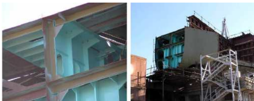
Slika : Pogled na krmeni peak u gradnji (Izvor: Brodosplit – Brodogradilište d.o.o. Split)
