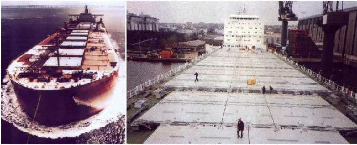
Slika : Grotla s poklopcima broda za rasute terete i broda za prijevoz spremnika (Izvor: Brodogradilište, Samsung Heavy Industries Co Ltd., S. Korea, 2008 god.)
