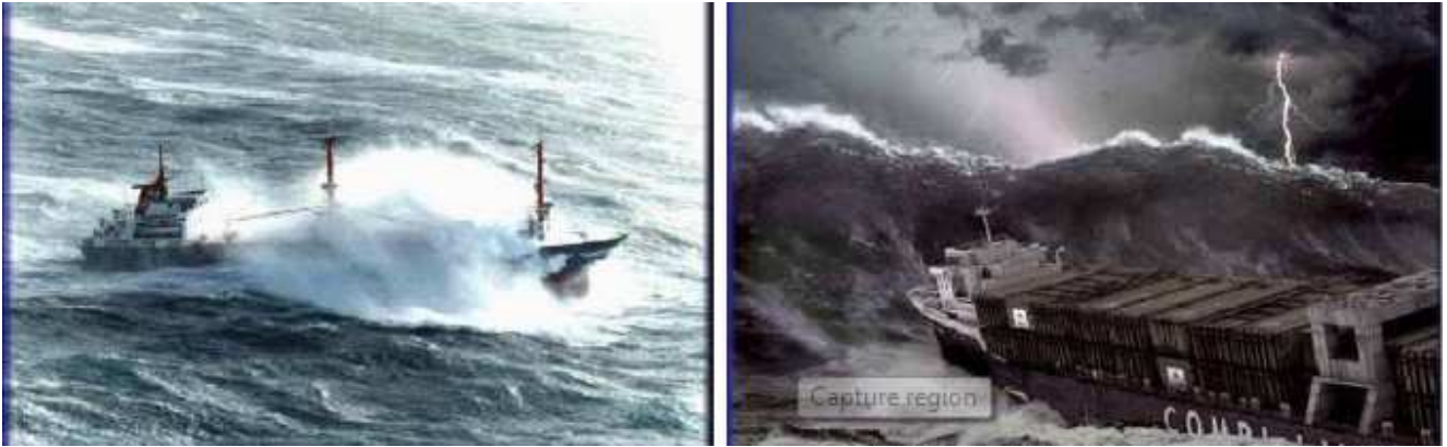
Slika : Opterećenja poklopaca uslijed prelijevanja mora i uslijed tereta na palubi (Izvor: http://en.wikipedia.org )
