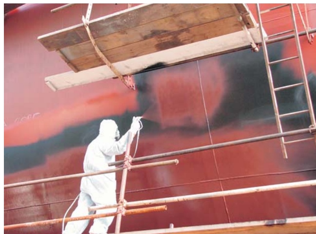
Slika 5 Nanošenje AF premaza na navozu Brodogradilišta Uljanik, Pula
