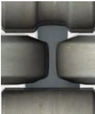
Sistem profilnih valjaka za višefazno valjanje šina
