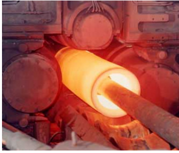
Mannesmannov postupak izrade cijevnice
