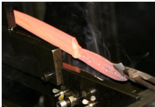
Vađenje otkivka iz jednofaznog ukovnja
