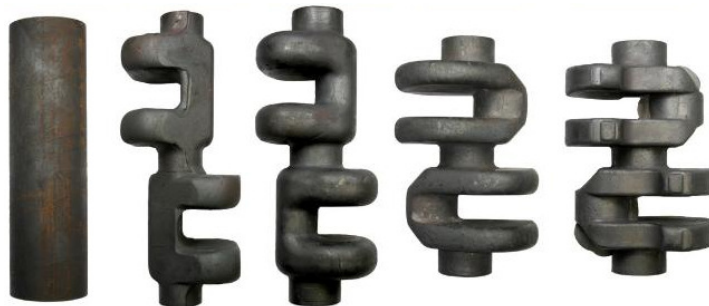
Sirovac , tri međufaze i konačni izgled otkivka (koljenasto vratilo)
