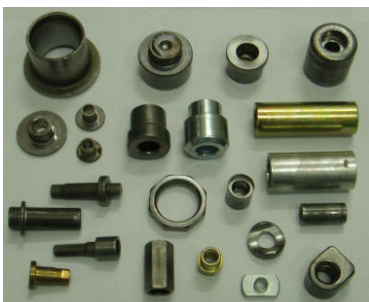
Otkivci dobiveni hladnim kovanjem u ukovnjima
