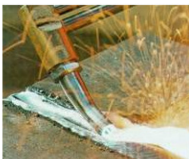
Plameno dubljenje slijedi načelo plamenog rezanja. Za razliku od procesa rezanja, koristi se zakrivljena mlaznica za autogeno rubljenje. Izgorjeli materijal (šljaka) se uklanja iz utora puštanjem veće količine kisika - mlazom. Ovaj proces je posebno pogodan za uklanjanje neispravnih zavora.
