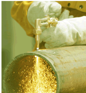
Rezanje plamenom – plamenik ima dodatni dovod čistog kisika koji izlazi u jakom mlazu i uklanja rastaljeni metal (metal izgara u velikoj količini kisika).
