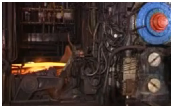
Valjanje trake u toplom stanju kroz duo valjke
