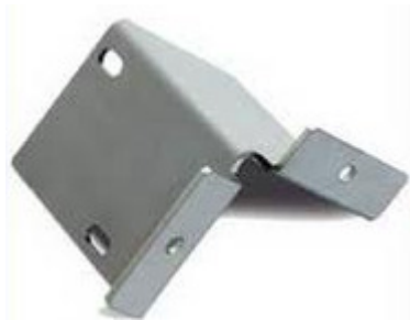
Noslač- proizvod nakon 3 kutna savijanja i bušenja
