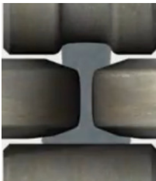
Sistem profilnih valjaka za višefazno valjanje šina
