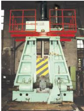
Vertikalne hidrauličke preše sa dvoradnim cilindrom
