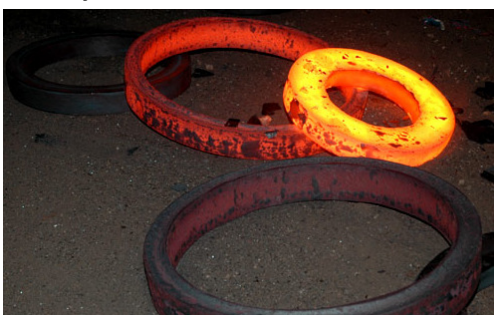
Slobodno kovanje bez kalupa - iskivanje
