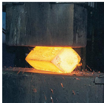
Slobodno kovanje bez kalupa - iskivanje
