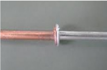
Hladno zavareni spoj
