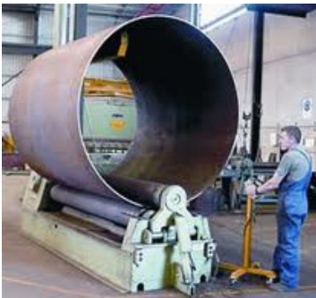
Kružna savijanja lima na savijačicama s 3 valjka
