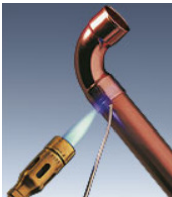
Nanošenje lema kod tvrdog lemljenja
