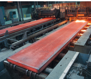
Uzdužno valjanje slaba
