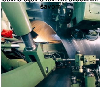
Izrada šavne cijevi sa spiralnim šavom
