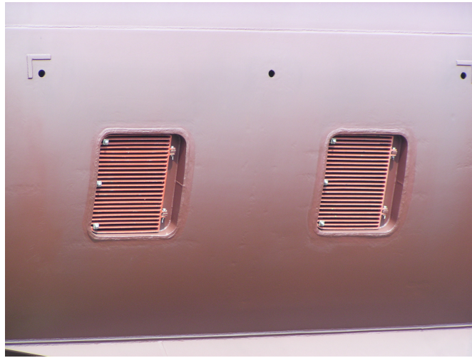
Slika xxx. Zaštitne rešetke kutija usis mora na oplati brodaskica s poprečnim presjekom i objašnjenjima elemenata
