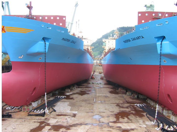
Slika xxx. Razvlačenje sidrenog lanca i polaganje sidara na pod doka
