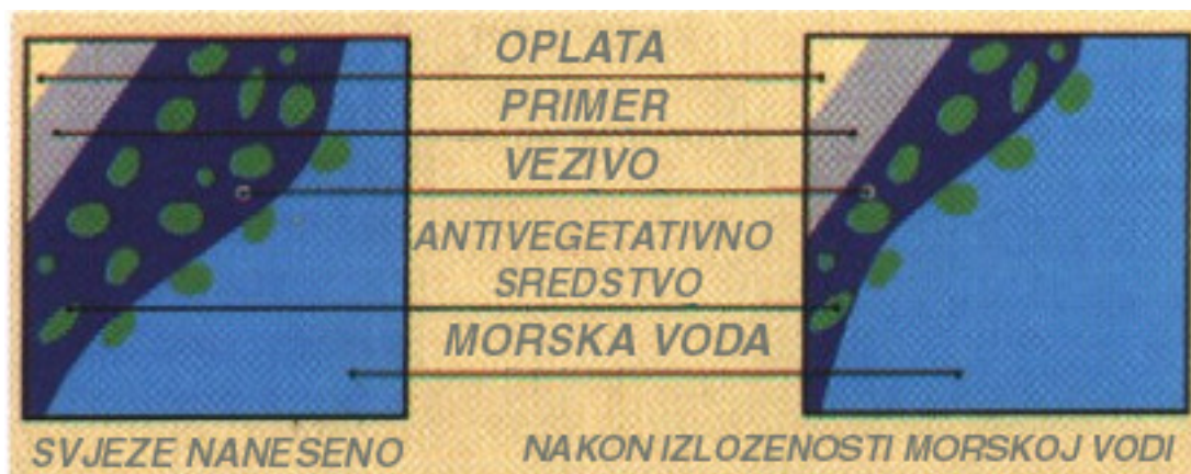
Slika xxx: Samopolirajući antivegetativni premaz
