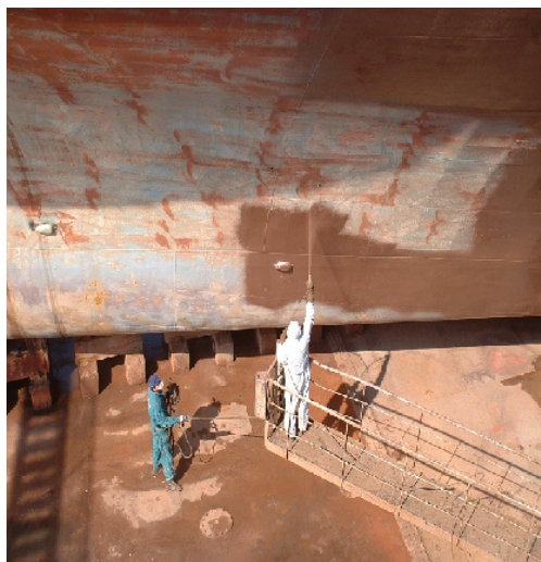
Slika xxx. Nanošenje temeljnog premaza na vanjsku oplatu broda
