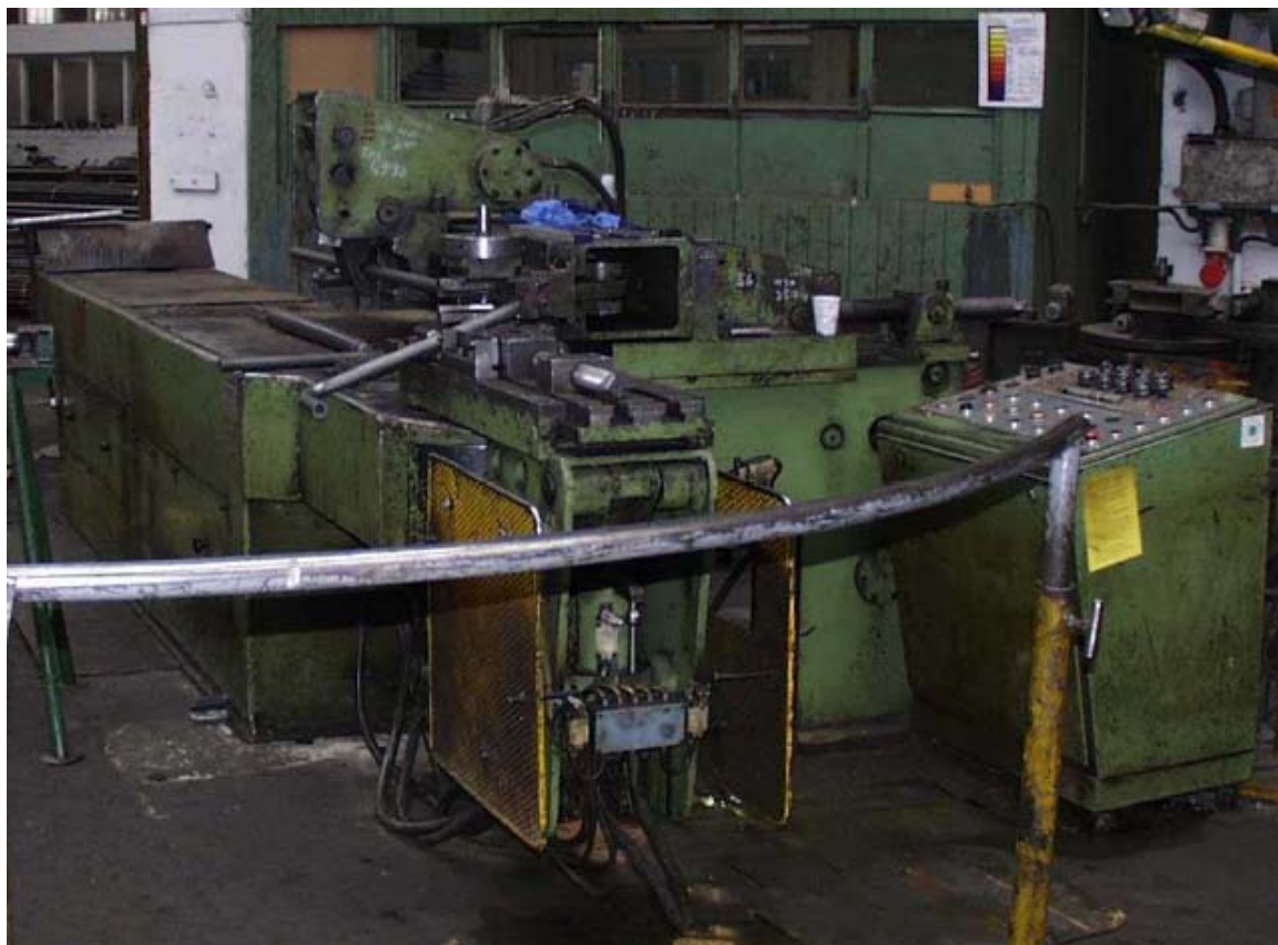
Slika 5.1 Stroj za hladno savijanje cijevi i pojedinačnih cijevnih lukova
