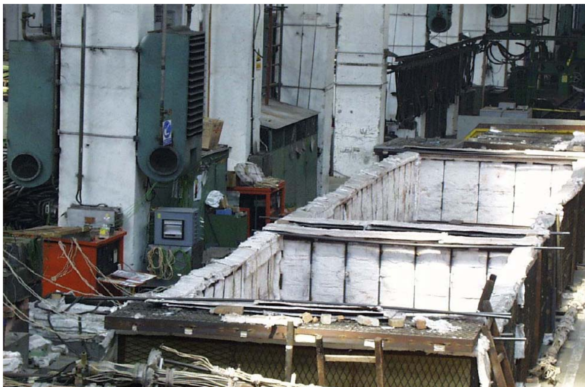
Slika 2.14 Elektrootporna peć za toplinsku obradu
