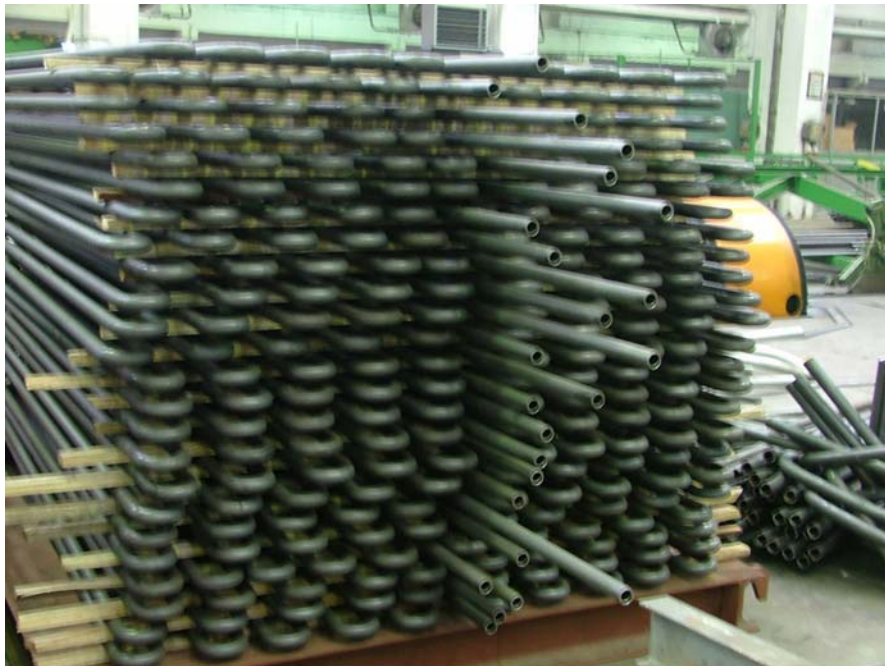
Slika 4.8 Savijene cijevi namijenjene za izradu "cijevne zmijs"
