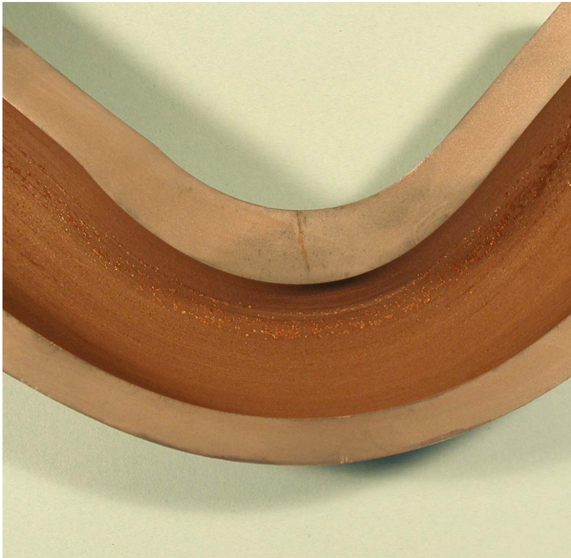
Slika 5.2 Savijeni prepolovljeni uzorak
