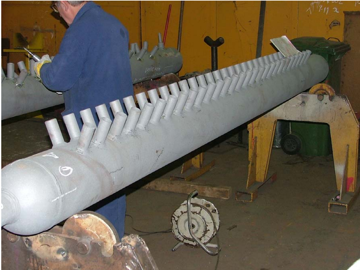
Slika 4.15 Komora kotla sa priključcima
