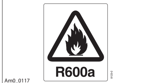
Slika 6: Etiketa na kompresoru sa R600a
