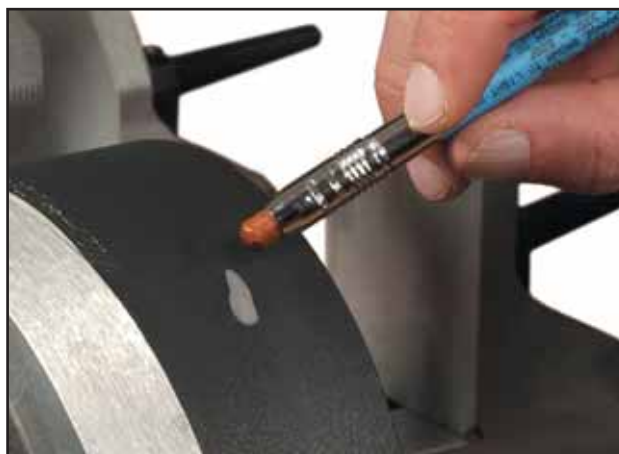
Kontrola temperature potezom termičke olovke
