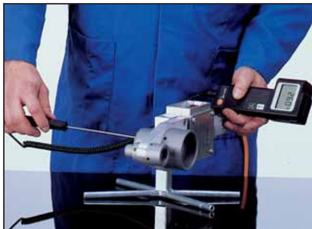
Kontrola temperature aparatom za mjerenje površine
