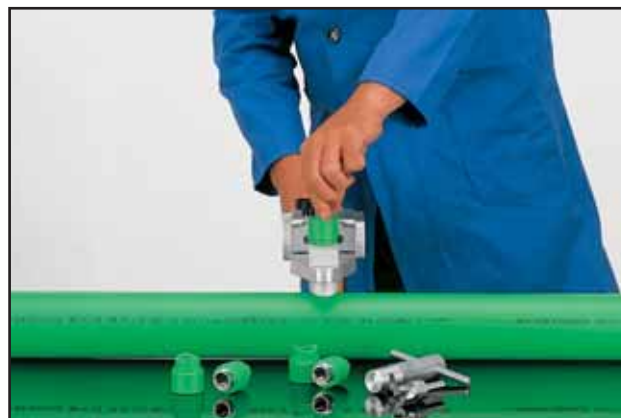
zagrijavanje elemenata spremnih za zavarivanje
