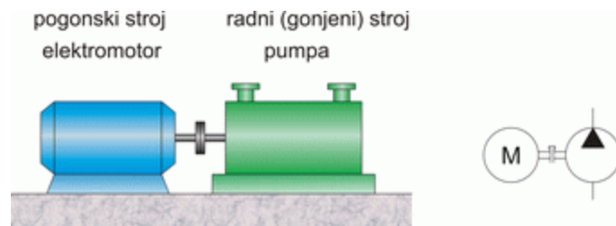
Slika 1. Pogonski i radni (gonjeni) stroj
