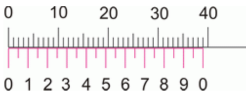
Slika 1.4. Nonij u kojem je 39 mm podijeljeno na 20 jednakih dijelova
