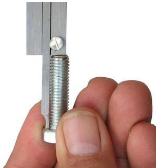
Slika 1.9. Mjerenje dubine univerzalnim pomičnim mjerilom
