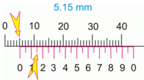
Slika 1.5. Čitanje mjere s pomičnog mjerila preciznosti 0.05mm
