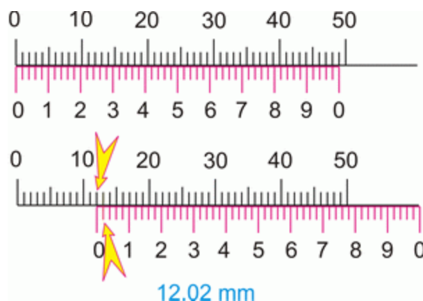
Slika 1.6. Čitanja mjere s pomičnog mjerila točnosti 0.02 mm
