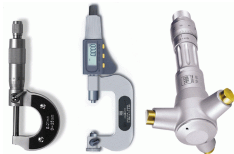
Slika 1.10. Mikrometri za vanjska i mikrometar za unutarnja mjerenja
