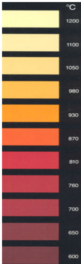
Boje čelika pri povišenoj temperaturi
