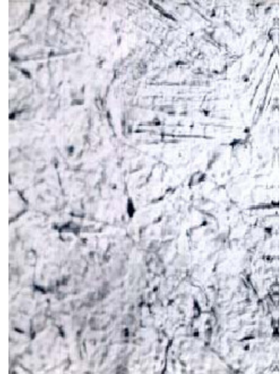
Temperatura 300°C Veličina zrna nije jasno vidljiva zbog ubrzanog hlađenja
