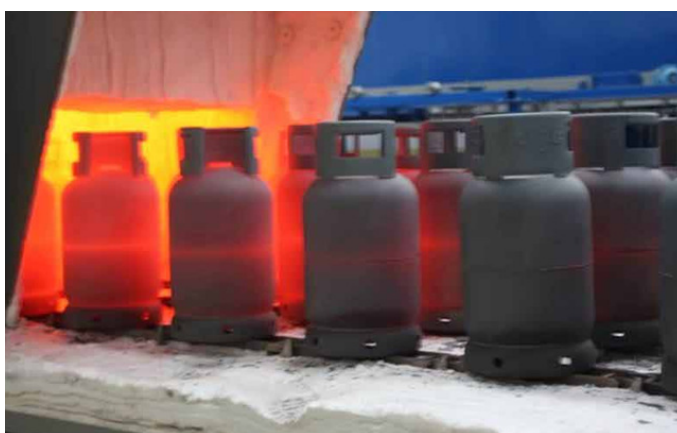
Termička obrada zavarenih boca za plin popuštanjem
