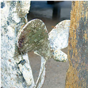
Elektrokemijska korozija na propeleru broda
