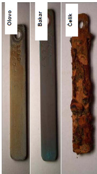
Korozija različitih metala izloženih u istim elektrolitima u istom vremenskom intervalu
