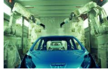
Ručno nanošenje boje u komori za lakiranje i lakiranje pomoću robota
