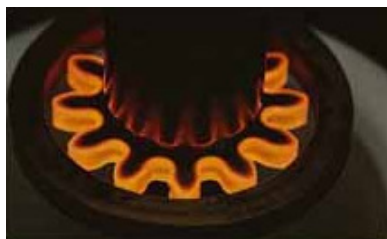
Površinsko zagrijavanje plamenom zupčanika za kaljenje
