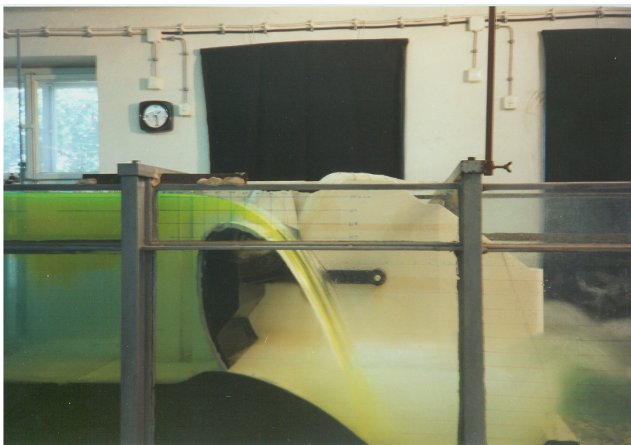
Slika 13.2 – prikaz fizikalnog modela preljeva izvedenog u hidrotehničkom laboratoriju GFZ (Froudeova sličnost ; L_r = \dots )
