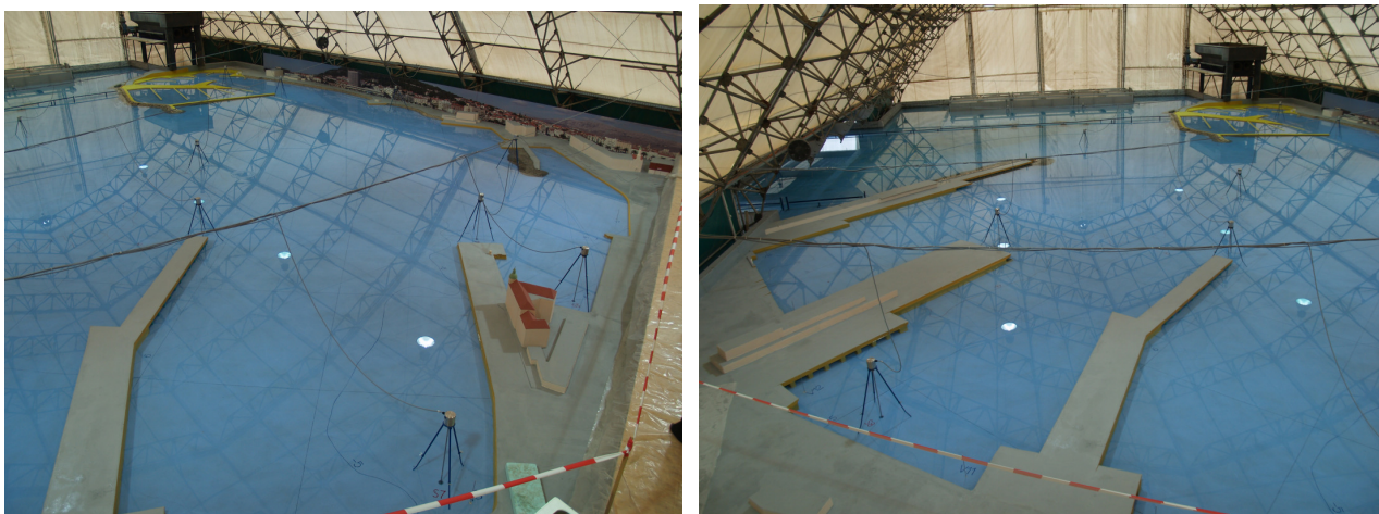
Slika 13.4a,b - prikaz fizikalnog modela luke Split izvedenog u hidrotehničkom laboratoriju IGH (Froudeova sličnost ; L_r = 50 ; izgled fizikalnog modela Gradske luke Split – pogled na sjevernu (lijevo) i južnu (desno) stranu luke)
