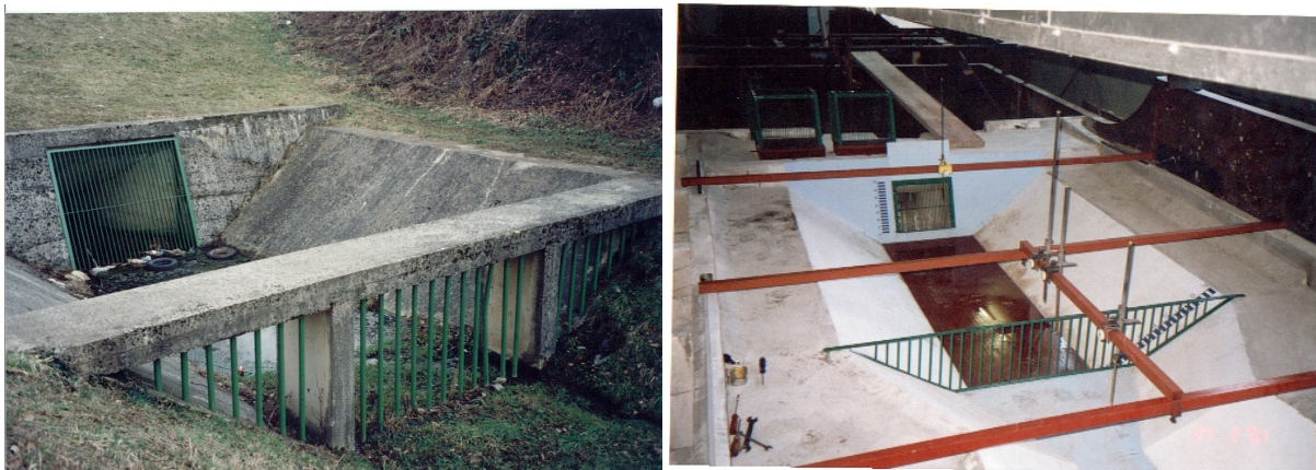
Slika 13.6 - prikaz prototipa (lijevo) i fizikalnog modela (desno) dionice dovodnog kanala predrešetke, taložnice i rešetke na ulazu u temeljni ispust retencije „Kuniščak“ u Zagrebu ( model izveden u hidrotehničkom laboratoriju GFZ ; Froudeova sličnost ; L_r = 5 )
