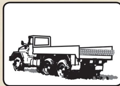
Slika 3. Ispravan način transporta cijevi
