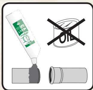
Slika 10. Spajanje dvije cijevi pomoću masti za montažu
