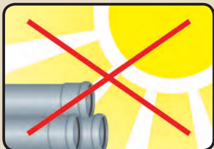
Slika 4. Neispravan način skladištenja cijevi
