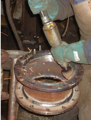
Slika xxx. Brušenje zavarenog prirubničkog spoja
