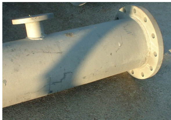
Slika xxx. Detalj ogranka na osnovnoj cijevi
