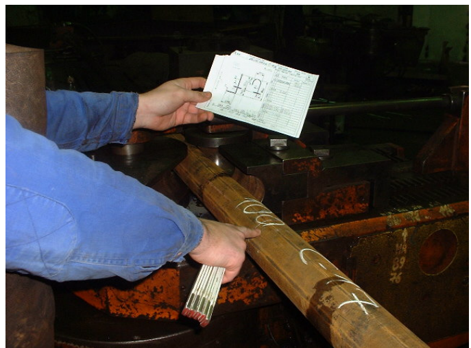
Slika xxx. Trasiranje cijevi na osnovi traserske crte s mjerne skice obrađene cijevi
