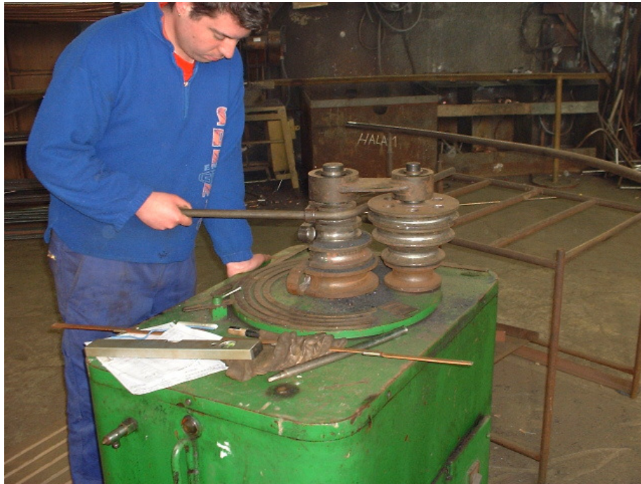
Savijanje cijevi savijačicom bez unutarnjeg trna
