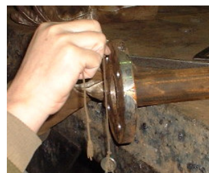
Slika xxx. Način mjerenja kuta zaokreta prirubnice
