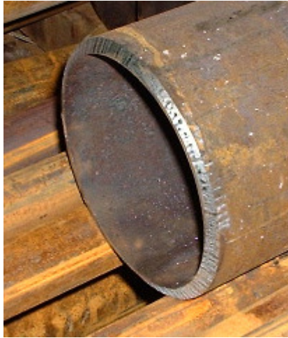
Slika xxx. Priprema kraja cijevi za zavarivanje
