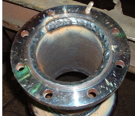
Slika xxx. Zavareni prirubnički spoj prije brušenja
