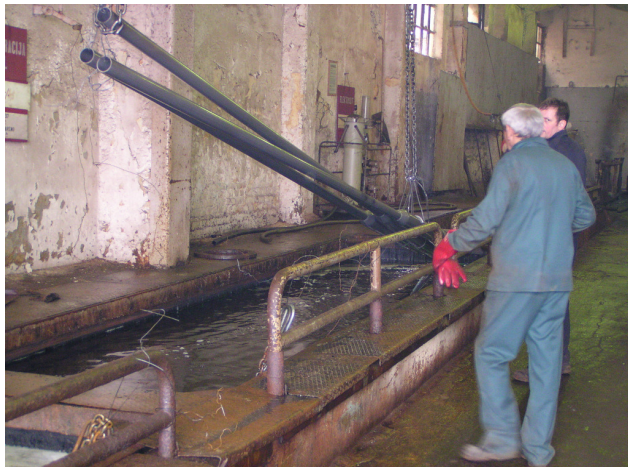
Slika xxx. Kada s klorovodičnom kiselinom za kemijsko tretiranje cijevi prije pocinčavanja
