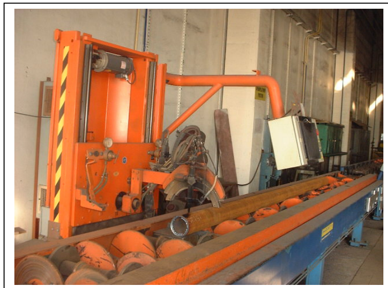
Slika xxx. NC stroj za rezanje otvora i prodora
