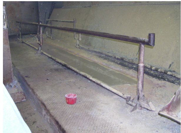
Slika xxx. Kada za pocinčavanje cijevi
