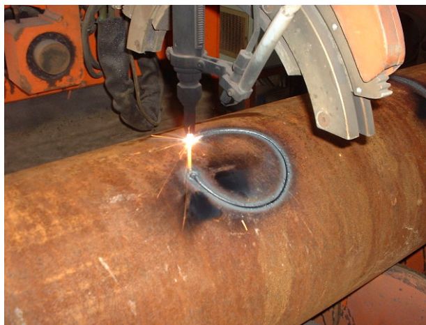
Slika xxx. Rezanje prodora na NC stroju
