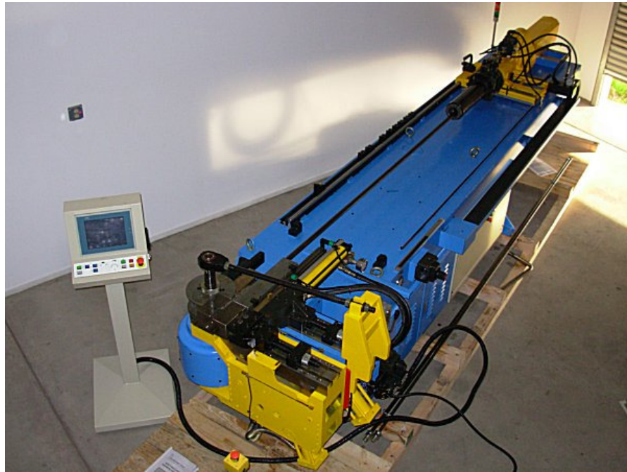
Slika xxx. CNC stroj za savijanje cijevi
