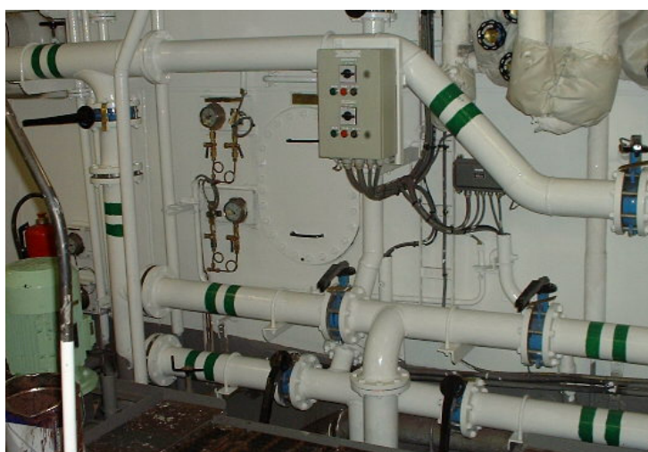
Slika xxx. Primjer označavanja službi cjevovoda bojenjem na brodu
