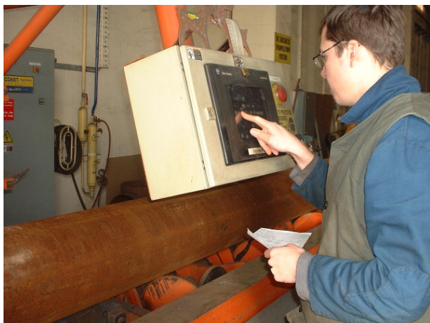
Slika xxx. Unošenje podataka za rezanje prodora
