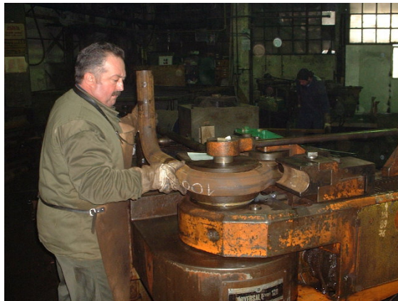
Slika xxx. Izrada savijene cijevi na stroju za savijanje
