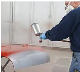
Ručno nanošenje boje u komori za lakiranje i lakiranje pomoću robota
