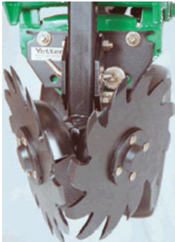
Visoko popušteni čelik na noževima alata
