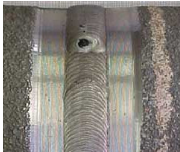
Zavarivanje nehrđajućeg čelika pogoduje stvaranju interkristalne korozije
