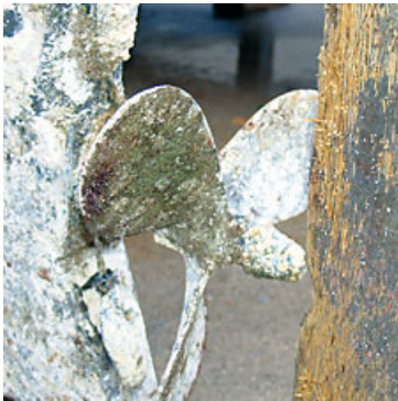
Elektrokemijska korozija na propeleru broda
