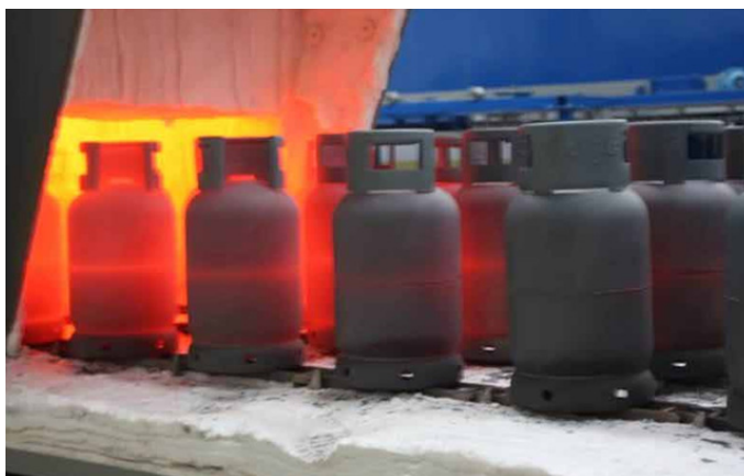
Termička obrada zavarenih boca za plin popuštanjem
