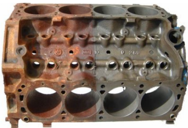
Blok motora nezaštićen (lijevi dio) i zaštićen (desni dio) od korozije
