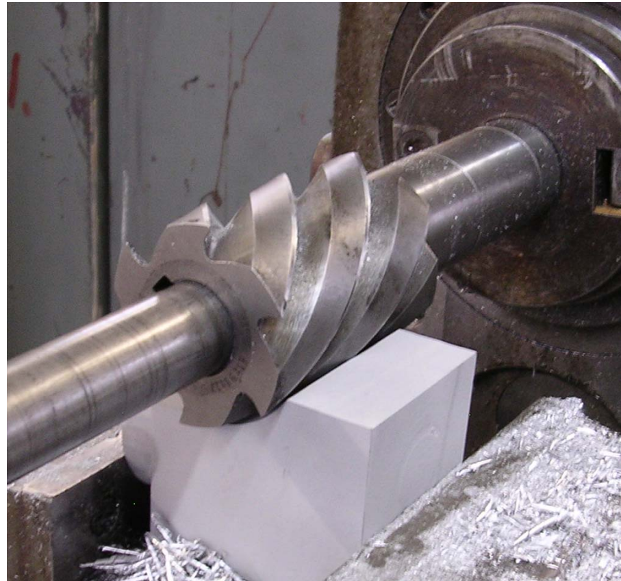
Obodno ravno glodanje - istosmjerno
