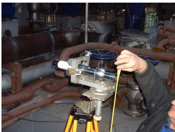
Slika xxx. Određivanje položaja krajnje točke na temeljnoj ploči glavnog motora
