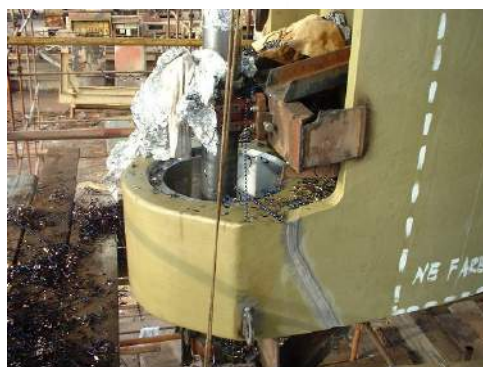
Slika xxx. Bareniranje odljevka roga statve
