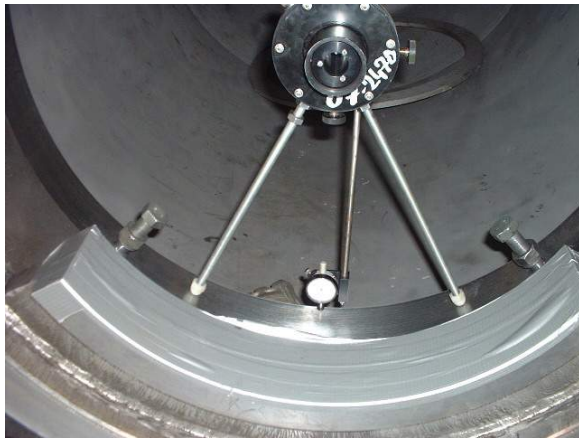
Slika xxx. Postavljanje mete u centar stražnjeg ležaja statvene cijevi
