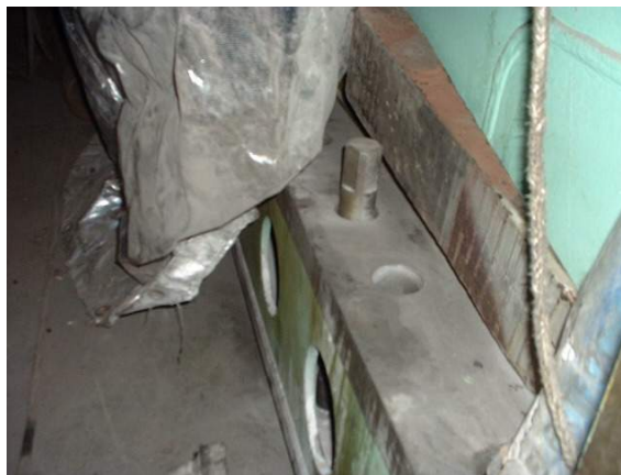
Slika xxx. Vijci na glavnom motoru za vertikalno niveliranje
