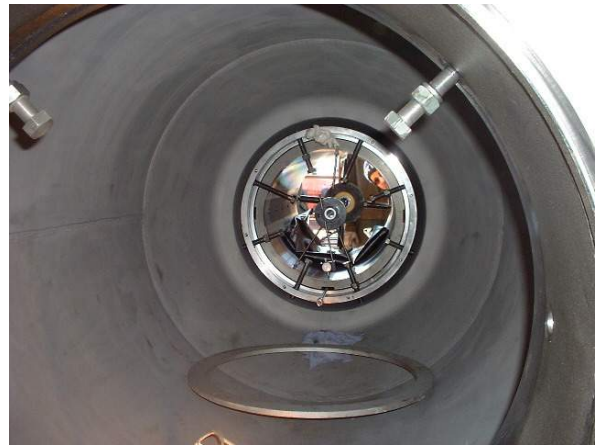
Slika xxx. Postavljanje mete u centar stražnjeg ležaja statvene cijevi
