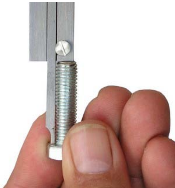
Slika 1.9. Mjerenje dubine univerzalnim pomičnim mjerilom
