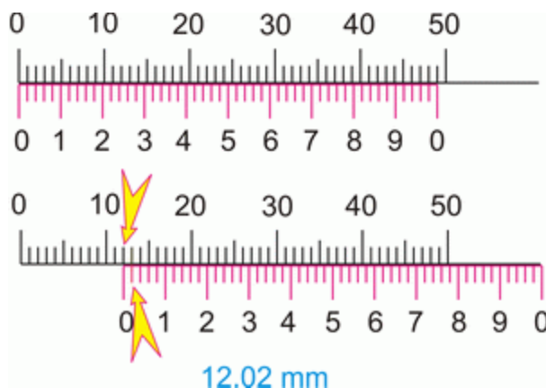
Slika 1.6. Čitanja mjere s pomičnog mjerila točnosti 0.02 mm
