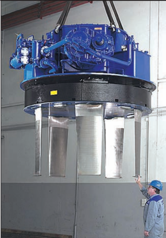
Slika 1. Fotografija Voith-Schneiderova propulzora Figure 1. Photo of Voith-Schneider propulsion unit
