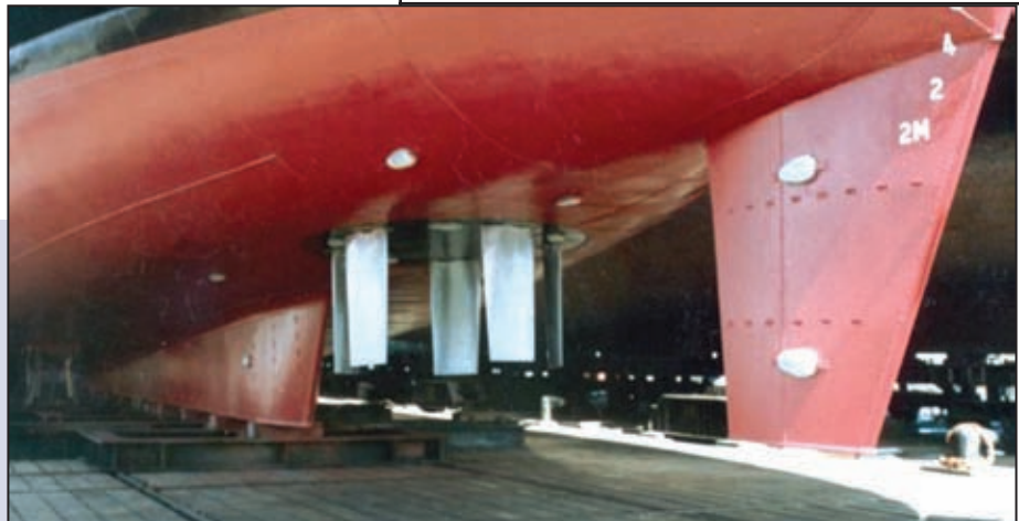
Slika 8. Fotografija kreme broda s Voith-Schneiderovim porivnim uređajem Figure 8. Photo of a stern of Voith-Schneider propulsion device
