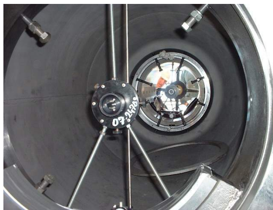
Slika xxx. Postavljanje mete u centar prednjeg ležaja statvene cijevi
