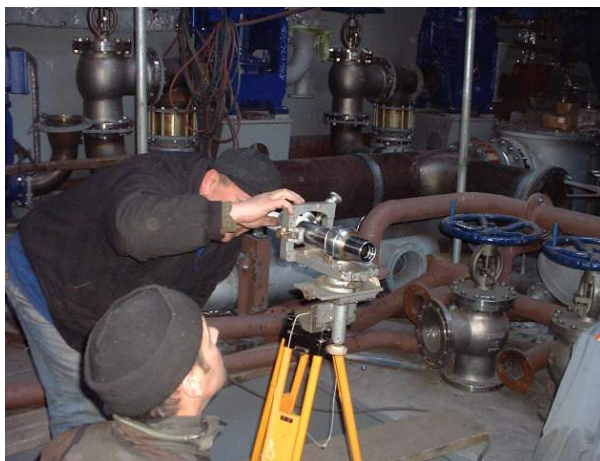
Slika xxx. Centriranje ležajeva statvene cijevi
