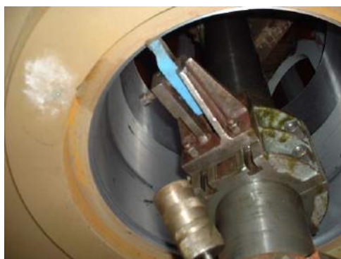
Slika xxx. Bareniranje odljevka struka kormila
