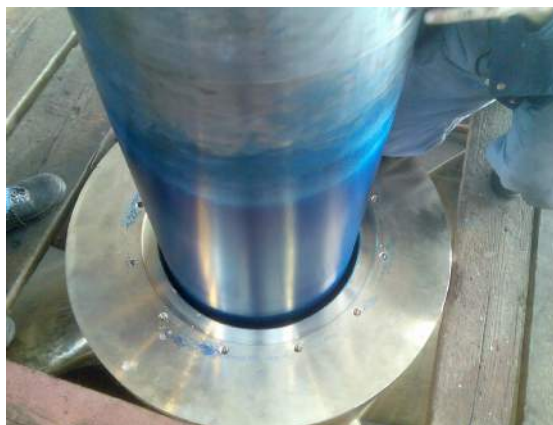
Slika xxxx. Osovina broskog vijka ulazi u glavčinu broskog vijka da bi se izvršio "blue print"
