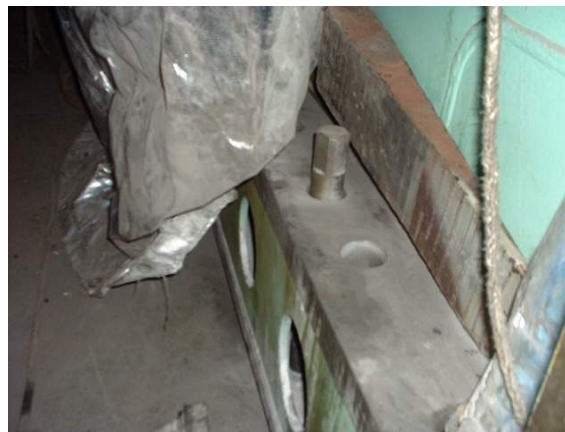
Slika xxx. Vijci na glavnom motoru za vertikalno niveliranje
